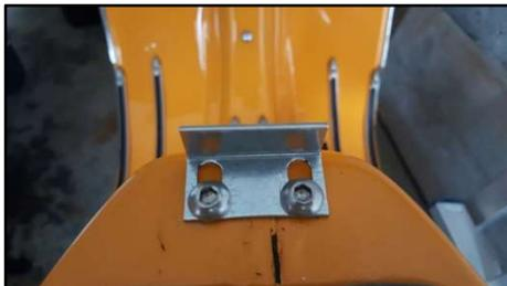
**Schritt 8:** Den Verriegelungswinkel zusammen mit den M7x20 Sechskantschrauben und Unterlegscheiben laut Bild links am Rahmen einsetzen. Winkel mit Hilfe der Langlöcher ganz nach vorne verschieben und mit den Schrauben die Position fixieren.
