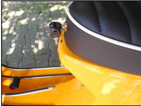
**Schritt 6:** Nun die Bank an der Spitze sowie am Heck anheben und das eventuell vorhandene Vertikalspiel durch Verringern der Schraubenhöhe minimieren. Anschließend die Höhe der Schrauben mit den Kontermuttern fixieren. Lässt sich die Bank nicht aufschieben, die Schrauben weiter herausdrehen bis sich diese aufsetzen lässt. Bei großer Schwergängigkeit evtl. die Langlöcher im Blech leicht mit einer Feile nachbearbeiten.
