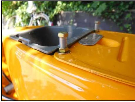
**Schritt 5:** Die drei M7x55 Inbus-Linsenschrauben zusammen mit den Muttern und Unterlegscheiben an der Vorder- und Hinterseite des Tanks einschrauben. Hinten die M7x40 Schlitzschraube verwenden. Kontermuttern leicht fixieren. Die Bank probeweise auf die Schrauben aufsetzen und nach hinten schieben.
