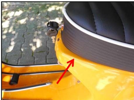
**Schritt 7:** Vorne durch den Spalt zwischen Sitzbank und Rahmen schauen und die beiden vorderen Gummipuffer soweit herausdrehen, bis diese knapp über dem Rahmen sitzen (Sitzbank muss sich noch aufschieben lassen). Höhe der Puffer wieder mit den Kontermuttern fixieren.
